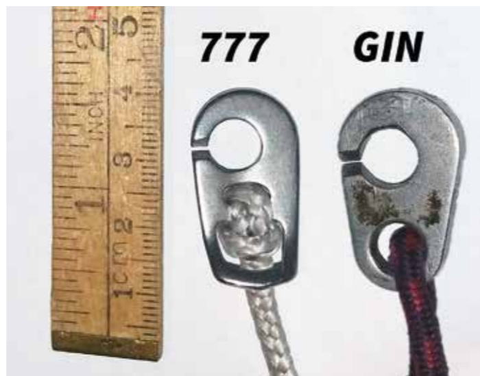
Brummelhakarna från Gillis utrustning, skärmen från Triple-Seven (777) och selen från Gin. Notera den stora skillnaden i öppningsmått! Det var haken från 777 som fastnade i selen.
