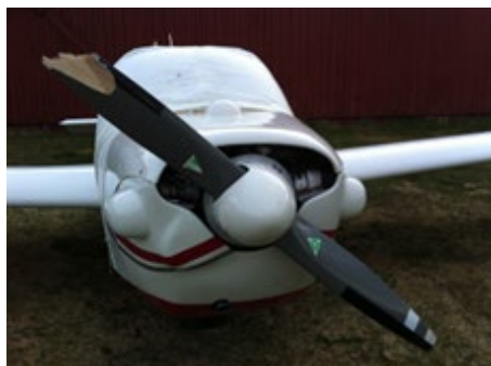
Typisk incident med TMG: skadade propellerspetsar
